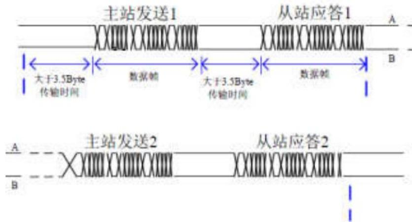
系列变频器内置的通信协议是 Modbus-RTU 从机通信协议，可响应主机的“查询/ 命令”，或根据主机的“查询/ 命令”做出相应的动作，并通讯数据应答。主机可以是指个人计算机（PC），工业控制设备或可编程逻辑控制器（PLC）等，主机既能对某个从机单独进行通信，也能对所有下位从机发布广播信息。对于主机的单独访问“查询/ 命令”，被访问从机要返回一个应答帧；对于主机发出的广播信息，从机无需反馈响应给主机。
